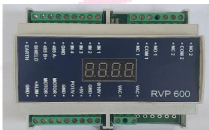
**IL DISPLAY A QUATTRO CIFRE CHE PERMETTE DI VISUALIZZARE IL VALORE DI TENSIONE IN USCITA E' UN'OPZIONE.**
